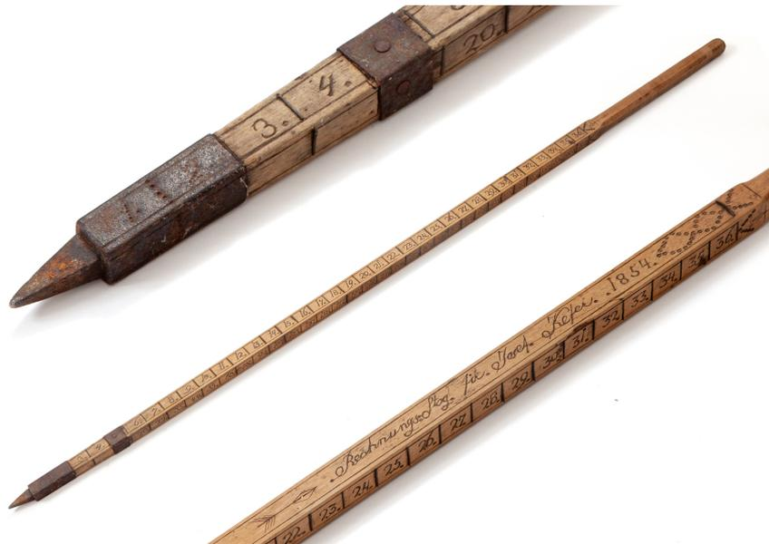
Der Stock mit quadratischem Querschnitt ist ca. 130 cm lang, trägt auf einer Seite die Inschrift „Rechnungs:Stog. fir. Josef. Kefer. 1854.“, die anderen drei Seiten zeigen unterschiedliche Skalen, einmal bis 36 Zoll und einmal bis 3 Fuß (12 Zoll = 1 Fuß). Die vierte Seite des Stockes trägt die Zahlenreihe: „20 27 35 44 55 66 78 92 107 123 140 158 177 197 218 241 264 289 314 341 369 398 428 459 491 525 559 594 631 668 707“.
