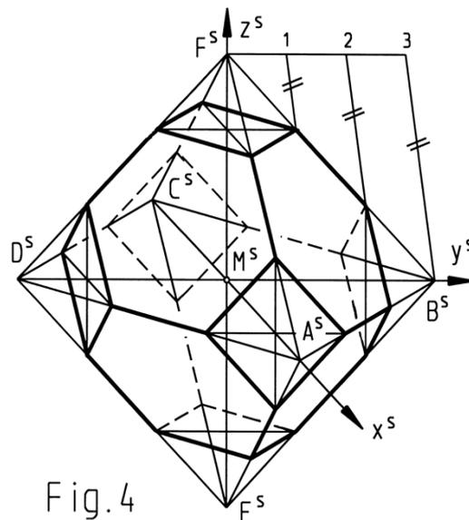
Das *abgestumpfte Oktaeder* ist ein von sechs Quadraten (als Schnittflächen) und acht regelm. Sechsecken begrenzter Archimedischer Körper, wie er in Fig. 4 dargestellt ist. Die Kantendritteln erfolgt nach der einschlägigen Konstruktion.
